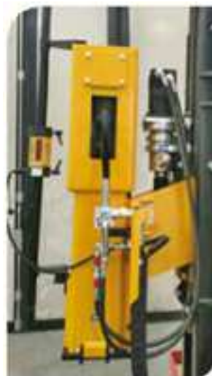
SZÖGLETES OSZLOPOK FORGATÁSAHOZ FORGATHATÓ OSZLOPVERŐ KIEGÉSZÍTŐ (tartozék)
