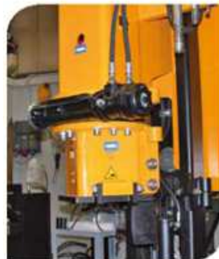
SZÖGLETES OSZLOPOK FORGATÁSAHOZ FORGATHATÓ OSZLOPVERŐ KIEGÉSZÍTŐ (tartozék)
