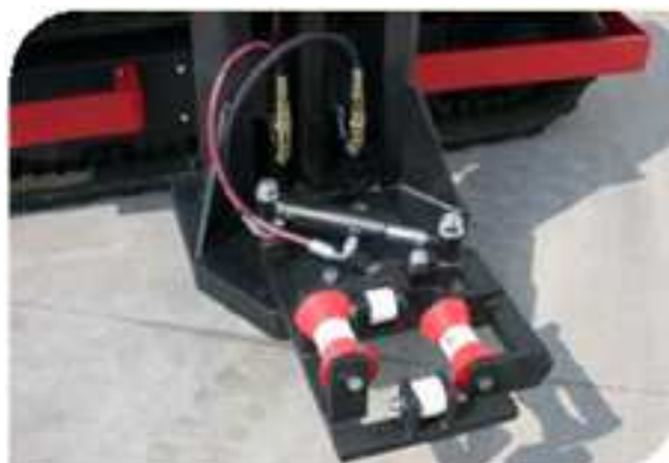
HIDRAULIKUSAN VEZÉRELT MŰANYAG ALSÓ VEZETŐGÖRGŐK A FAFELÜLETEK VÉDELME ÉRDEKÉBEN (tartozék)
